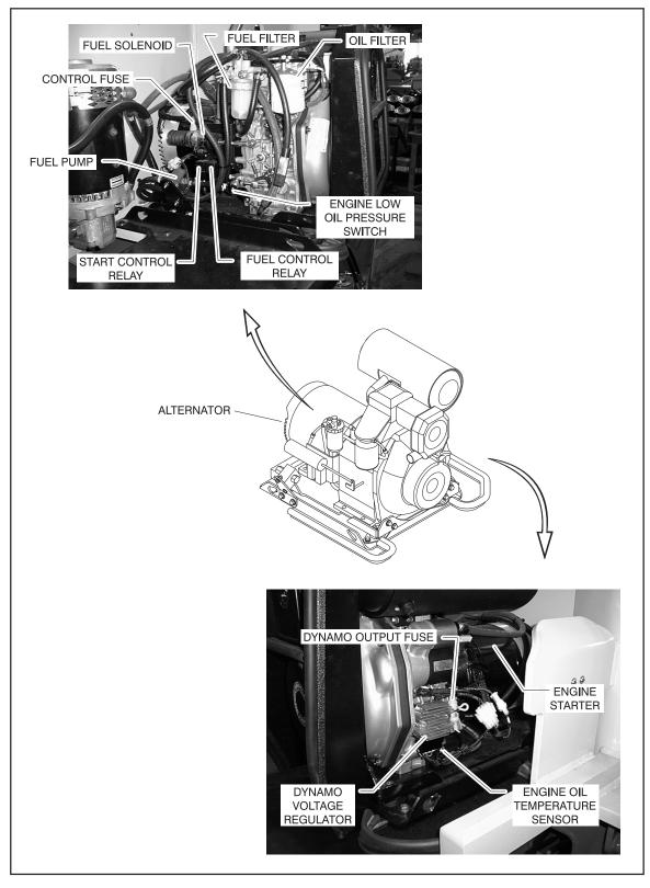
Figure 3-9. Generator Components
